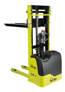
Die neue GX Baureihe ist die ideale Deichselstapler Lösung für den gewerblichen Gelegenheitseinatz auf kleineren bis mittleren Lagerflächen. Mit einer Gesamtbreite von nur 800 mm und der seitlich angeordneten Deichsel ist der neue GX äußerst wendig, standfest und ermöglicht immer freie Sicht zu den aufzunehmenden Lasten. Integrierte Batterien und das integrierte HF-Ladegerät machen den GX zur kompletten Lösung Ihrer Lageraufgaben.
